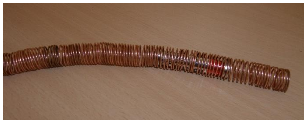
Obr. 17 Magnetický vláček uvnitř pružiny (cívky) z měděného drátu.
